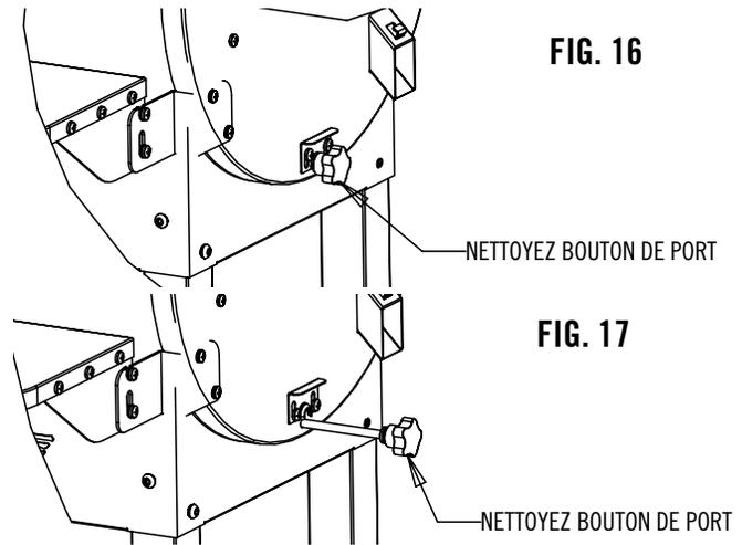
**Installation du bouton de nettoyage de la trémie**
