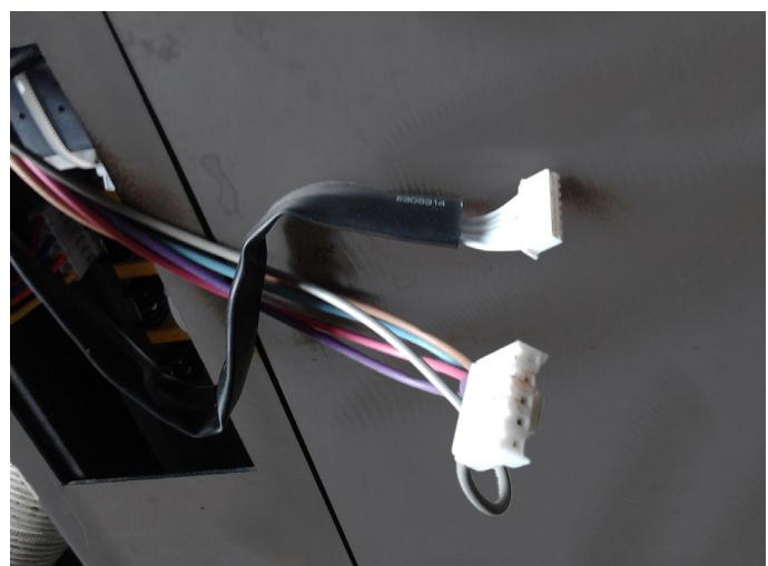
1. Tirez les fils installés en usine sur le dessus du poêle. Il y aura deux faisceaux de câbles, comme illustré.
