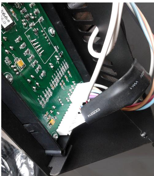
3. Connectez les installations en usine faisceau de câblage sur le panneau de commande comme indiqué.
