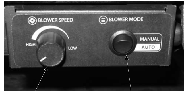
Blower Speed Control Knob (rheostat)
