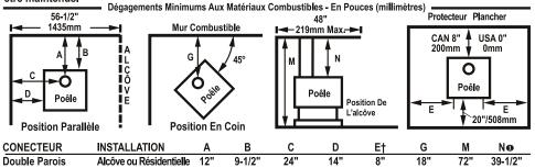
6" OU 8" de diamètre Maison Mobile\* 305mm 241mm 610mm 356mm 200mm 450mm 1829mm 1003mm
